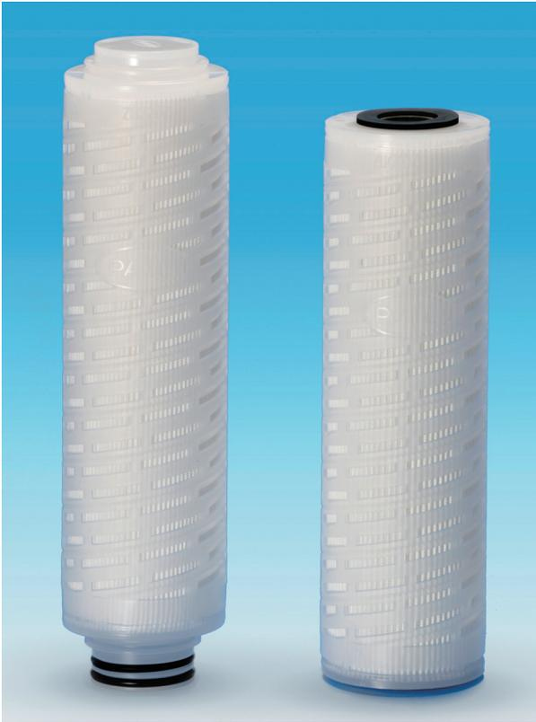
“ウルチポアGFプラス”は、粒子の除去効率を一段と高めるために静電気の吸着効果を利用したフィルターカートリッジです。水や水溶液のろ過では、「静電吸着機能」により、フィルターの孔径よりも相当小さい粒子が除去されます。微粒子や微生物など多くの物質は、水系液中に浸した時、特有のゼータ電位を持ちます。マイナスに荷電した粒子の除去にはプラスのゼータ電位を持つ“ウルチポアGFプラス”が最適です。
