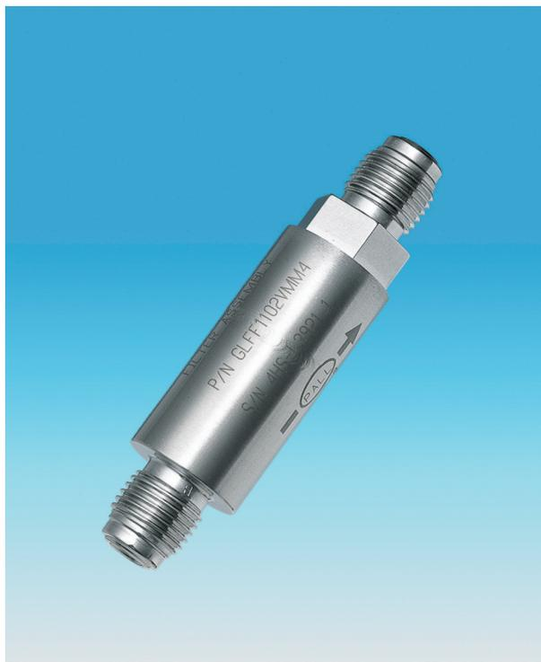
“ミニ・ウルトラメット-L” 1100シリーズは、オール316Lステンレススチール製で、半導体製造プロセス用高純度ガスの精密ろ過を目的に開発されたガスフィルターです。従来品“ミニ・ウルトラメット-L”の除粒子性能、流量-圧力損失特性等の優れた基本性能をそのままに、面間サイズの変更により汎用性を拡大し、大幅なコストダウンも実現しました。また、セマスペックによる定格付けを実施しているため、国外への輸出の際の利便性も持ち合わせています。
