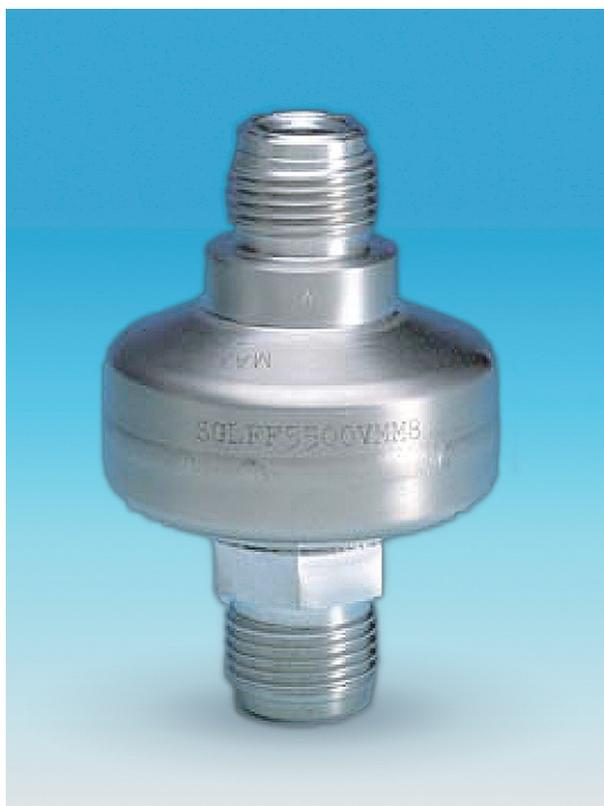
5500シリーズは、従来品“ウルトラメット-L ガスクリーン”の高流量対応タイプです。優れた除去性能やガス置換特性等の特長はそのままに、ハウジングには真空二重溶解材（VAR）を使用しています。さらに100NL/min程度の流量に対応可能ですので、CVDや拡散炉用のパージガスのろ過やTEOSのろ過等に適したフィルターです。
