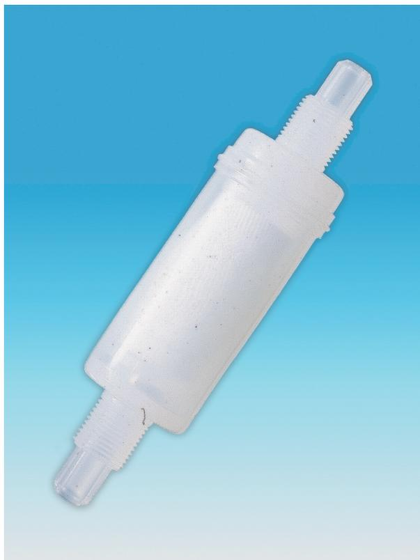
“ミニ・クリーンチェンジ”は、ドライブプロセスで実績のあるポール“ガスクリーンIV”のフィルターメディアを使用したディスプレイタイプオールフッ素樹脂製フィルターです。コンパクトな形状からは想像ができないほどの優れた流量-圧力損失特性を持つ画期的なフィルターです。ハウジング素材がPFA製のため、ウェットステーション中の窒素ガス等のろ過に安心して使用できます。
