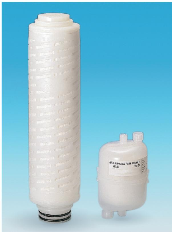
“イオンクリーン AQ”は、ポリエチレン膜にイオン交換基を化学修飾させた親水性メンブレンタイプの金属イオン除去フィルターです。イオン交換基には、純水中で強力に機能する強酸性カチオン交換基を採用しており、有機イオンなどの低減にも威力を発揮します。またイオン交換末端はすでに水素(H)に終端させていますので、超純水にもプレウェットせずにそのまま使用可能です。従来の塩酸等によるプレコンディショニング処理などが不要です。このため、通常のフィルター同様に取り扱えますので、設置にともなうダウンタイムを削減します。
