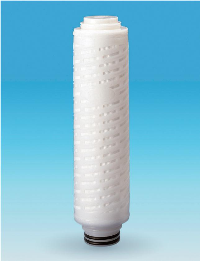
“ウルチプリーツ・P-ナイロン”は、フィルターメディアに親水性ナイロン6,6、ハードウェアに高密度ポリエチレン(HDPE)を使用しており、有機溶剤に優れた薬品適合性を持ったフィルターです。フォトレジストのろ過をはじめ、各種水溶液のろ過に最適です。“ウルチプリーツ・P-ナイロン”フィルターは、同一寸法のカートリッジでより大きなろ過表面積が可能な「ウルチプリーツ構造」を採用することにより、優れた流量特性と小型化を同時に実現しました。また、XPオプション(特殊洗浄)も新たに加わり、次世代リソグラフィ材料のろ過に最適です。
