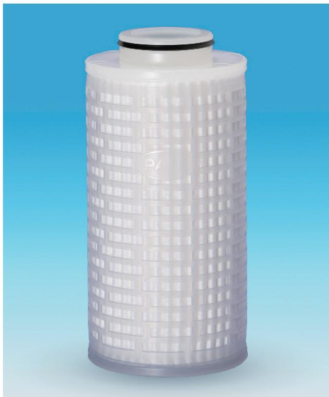
“ウルチプリーツ PK-GAS”ガスフィルターは、PTFEメンブレンとポリプロピレン製部品で構成された10インチサイズのカートリッジフィルターです。1本で10Nm<sup>3</sup>/minの処理能力を実現し、従来フィルターの3本分に相当します。使用本数を削減することができ、ガス供給システムにおいてコスト、スペースともに効率化ができます。
