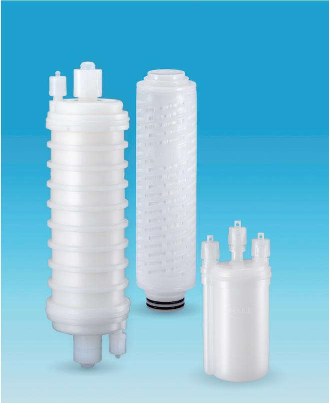
“ウルチプリーツSP DR”は、HFやBOEの循環ろ過用として、ナノメートル領域の除粒子性能を発揮し、高流量を実現したフィルターです。高非対称メンブレンにパル社独自のウルチプリーツ構造を採用することにより、高流量を実現。低い圧力でも循環ろ過効率を維持できます。立ち上がりが速くなるため、除粒子ばかりでなく、気泡の発生も抑制し、槽内のクリーンアップ改善に大きく貢献します。エッチング液や純水用など、幅広い用途に使用することができます。
