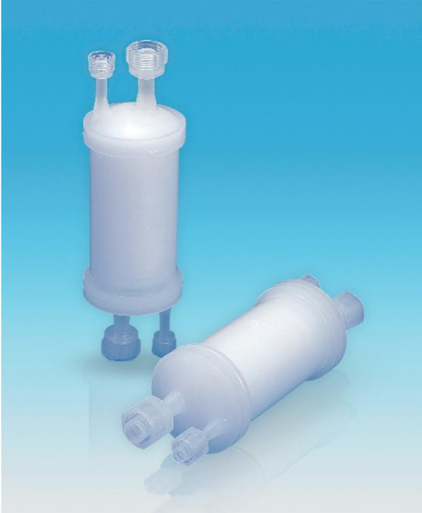
“ウルチクリーン・エクセラーER・JKC”は、通常のPTFE膜では通液不良が発生しやすい、発泡性流体の小流量ろ過用として開発された、高除粒子、大流量のオールフッ素樹脂製フィルターです。ポールの最新メディア表面改質技術により、メディアの乾きを抑制し、RCA洗浄プロセスで安定した流量が確保できます。濡れ性の高いフィルターですので、SC-1（アンモニア過水）、SC-2（塩酸過水）、SPM（硫酸過水）等、高純度発泡性流体に適しています。
