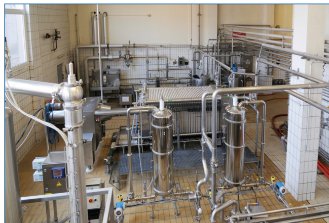
Abbildung 2: Bei Installation von einem Modul in einer Brauerei spart die SUPRApak Technologie im Vergleich zu klassischen Schichtenfiltern 68% der Betriebskosten ein.
