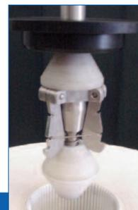
Hebevorrichtung für SUPRApak Module
