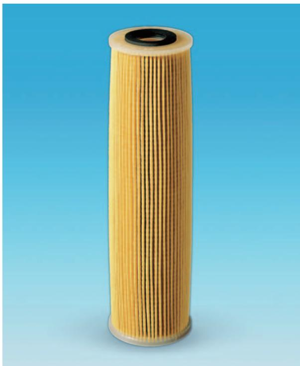
“エポセル”カートリッジはブリーツ状になっています。そのためろ過面積が大きくろ過寿命が長くなっています。材質はエポキシ樹脂含浸セルローズで孔が固定されているため、流量変動や機械的ショックによるメディアや異物の二次側への流出の心配がありません。“エポセル”のメディアには幅広い流体適合性があり、写真乳剤、現像液、潤滑油、印刷用インキなどの液体や、空気、窒素、天然ガスなどの気体のろ過にご使用いただけます。<sup>\*1</sup>
