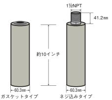
"PSS"-Sシリーズは、特殊な製法により、高い空隙率とより 均一な孔構造を持っています。従来の焼結金属フィルターに比べ、 より正確なろ過精度を持ち、さらに収塵能力は2倍、圧力損失は 2分の1になっています。また、溶接線のないシームレス構造の ため、機械的強度、耐熱性、化学的耐久性に優れています。
