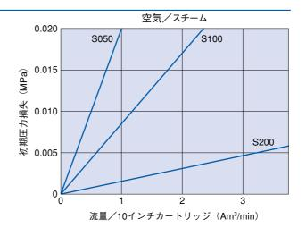
(注) 上記圧力損失はカートリッジのみの圧力損失です。
