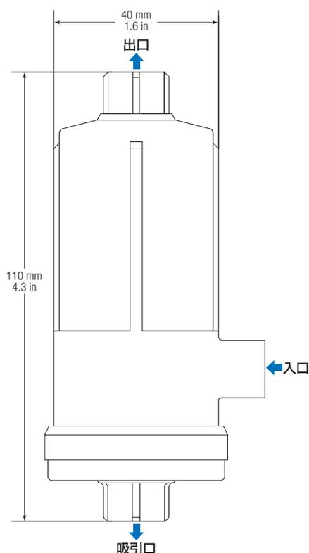
性能を最大限に発揮するためには、縦向きに取り付けてください。インクはゆっくりとウルチフューザーに注入してください。流速が遅いほど、ガスと中空糸膜の接触時間が長くなるため脱気効率が高まります。
