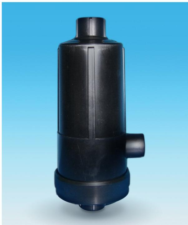
ウルチフューザー 41110 シリーズは、ポールの次世代型脱気モジュールです。UDM41110PT1は、産業用インクジェットプリンターのインク中の溶存酸素を低圧力損失で除去し、気泡の形成を抑えてプリンター性能を最適に維持します。
