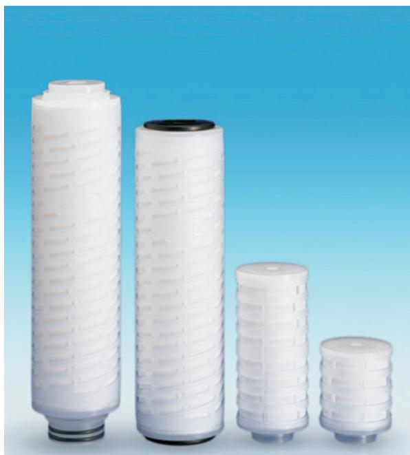
“エンフロン”は、PTFEメンブレン(0.05、0.1、0.2、0.45、1.0  $\mu\text{m}$ のろ過精度)とポリプロピレン製部品で構成されています。これらの材質により、幅広い耐薬品性があり、フォトレジストを始めとするリソグラフィプロセスで使用される有機溶剤、さらには洗浄プロセスで使用されるIPAをはじめとする洗浄液の精密ろ過に適しています。また、流量特性が優れているために、コンパクトサイズで、窒素ガス、乾燥エアのろ過が可能です(FRグレード)。\*1\*2
