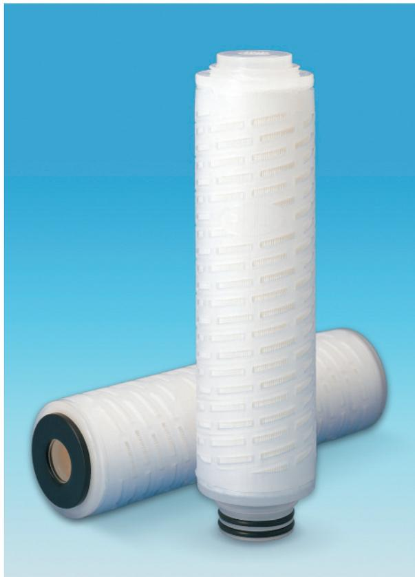
“フロロダインVA”は、親水化PVDF製メンブレンを使用したフィルターカートリッジで、水や水溶性薬品で容易に湿潤できます。また、メディアサポート、エンドキャップ等、メディア以外の構成部品はポリプロピレン製ですので、温純水および各種水溶性薬品のろ過に適しています。さらに、その優れた流量特性により、循環ろ過における槽内清浄度の立ち上がり時間を短縮できます。
