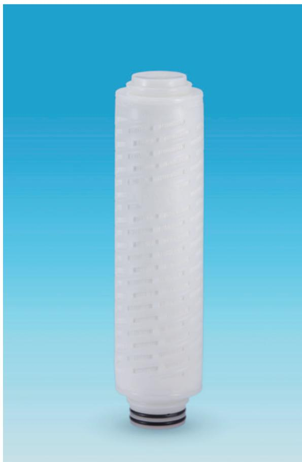
“ペンフロン”は、従来品“エンフロン”の流量特性および初期の抽出物量の改善を目的として開発されたフィルターです。大流量タイプの「ウルチブリーツ構造」を採用し、従来の“エンフロン”に比べ、流量特性が約25%改善しました。また、ハードウェアにはポリエチレンを使用したため、“ペンフロン”からの抽出物量は“エンフロン”のSグレード品（出荷前に塩化メチレンによる抽出処理を施したフィルター）と同等以下の値となっています。
