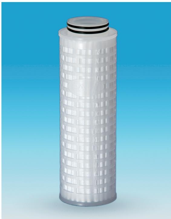
“ウルチプリーツ PKS” は、第6.5世代～最新世代のLCD製造プロセスで要求される250L/min以下の大流量を処理できるフィルターです。フィルターの小型化と交換コストの低減が可能です。ポリプロピレン、親水性高非対称ポリスルホン、親水性ポリエーテルスルホンおよびPTFEの4種類のろ材、および0.03 $\mu$ mから30 $\mu$ mのろ過精度の製品から、使用する薬液に最適なフィルターをお選びいただけます。
