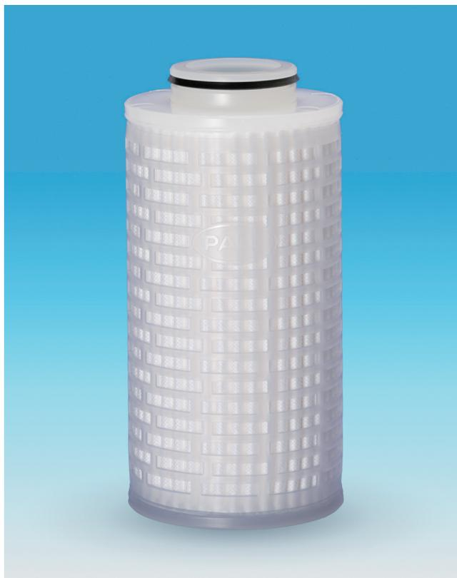
“ウルチプリーツPK EL”フィルターは、第7～10.5世代LCD製造プロセスで要求される300L/min以上の大流量を処理できるフィルターです。“ウルチプリーツPK EL”フィルターは異物濃度の高いアプリケーションやプレフィルター向けに開発されたポリプロピレン製のフィルターです。このようなアプリケーションにおいて、従来の製品ではフィルターの寿命が短いという問題がありましたが、膜面積の増加と膜構造により、この問題を解決しました。
