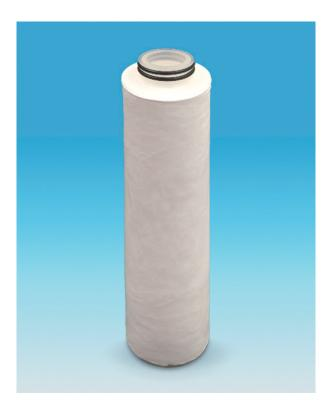
"プロファイルⅢ"(50 nm)フィルターは、最先端CMPスラリーろ週用として開発されました。ポールのメルトブロー技術を駆使して、さらに微細なファイバーを用いたメディアにより、非常に低い圧力損失を維持しながら、50 nmのろ週精度を実現しています。
