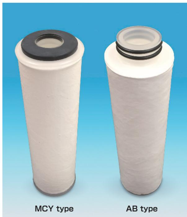
“プロファイルⅢ”フィルターは、オールポリプロピレン製デブスフィルターです。カートリッジの外側部分は微細なファイバーによる連続したテーパー孔構造となっています。樹脂バインダーは一切使用せず、パール独自のファイバー技術により固定されています。その結果、メディアの移行や剥離がありません。さらに、長いの過寿命とコスト削減を実現します。
