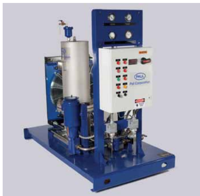
Система Pall VRF оснащена стандартными опциями охладителя
