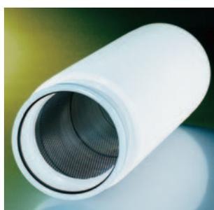
“ハイフロー・エンフロン”は、大型ガス供給システムに最適な気体用フィルターとして開発されました。大流量処理ではカートリッジの低差圧化が不可欠ですが、カートリッジフィルターのコアの内径が小さいことがネックとなっていました。そこで、カートリッジの大口径化を行い、オリフィス部の開口面積を広げることにより、低圧力損失で大流量処理を実現しました。40インチカートリッジ1本当りの最大処理流量は6,500Nm<sup>3</sup>/hrで、従来フィルター24本分（20インチ）に相当します。使用本数を大幅に削減することができ、大型化するガス供給システムにおいて、フィルターシステムの効率化を可能にします。
